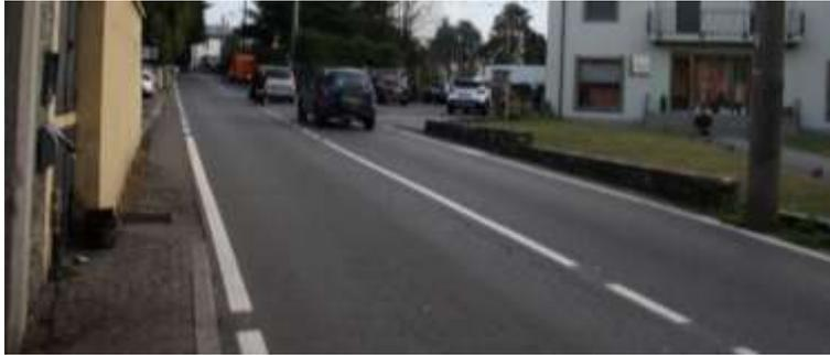
Foto 15 - Via S. Giacomo, percorso pedonale/banchina larghezza < 0,90 m, pavimentazione sconnessa
