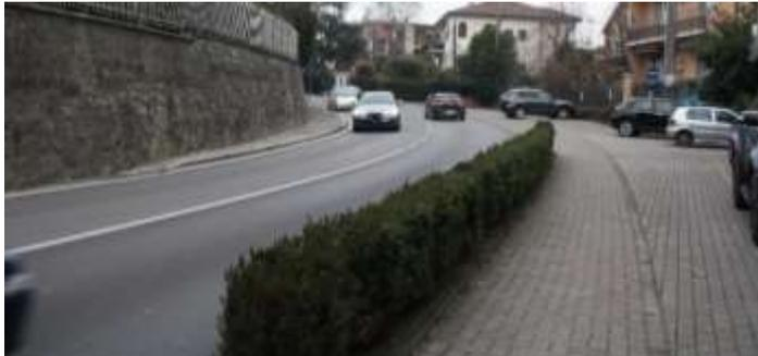
Foto 4 - Via Sirtori, interruzione banchina/marciapiede lato sx non segnalata
